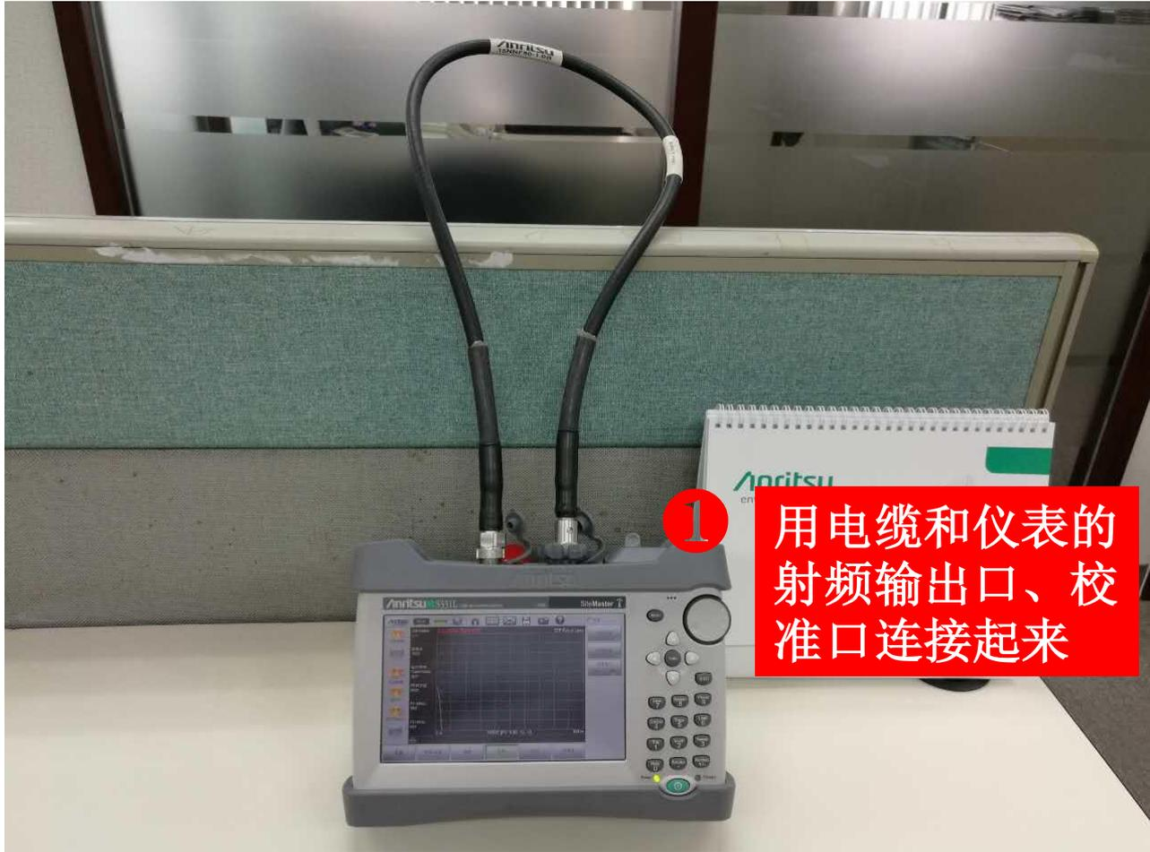
1 用电缆和仪表的射频输出口、校准口连接起来
