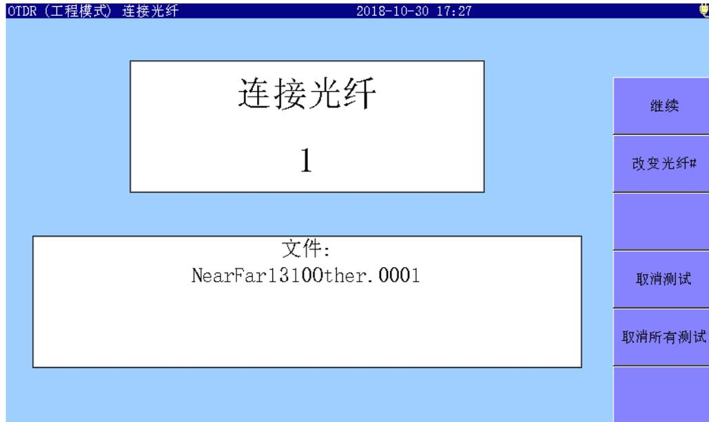
3. 将测试中的光纤连接到仪表并点击继续以开始测量。测量完成后确认测试结果，再点击预览打开。
