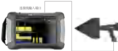
图9.12 手持式测向天线与FAT频谱分析仪连接示意图
