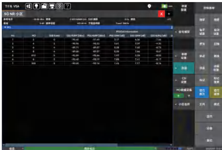
图9.4 5G NR信号多PCI测量显示界面
