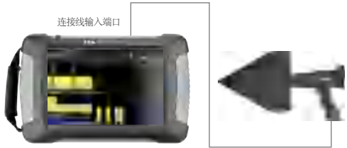
图9.14 手持式测向天线与FAT频谱分析仪连接示意图
