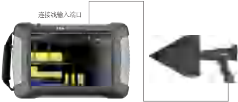
图8.11 手持式测向天线与FAT频谱分析仪连接示意图
