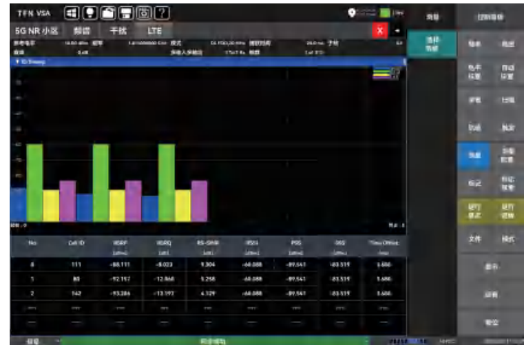
图8.12 固定频段ID扫描结果显示
