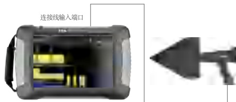
图7.4 手持式测向天线与FAT频谱分析仪连接示意图
